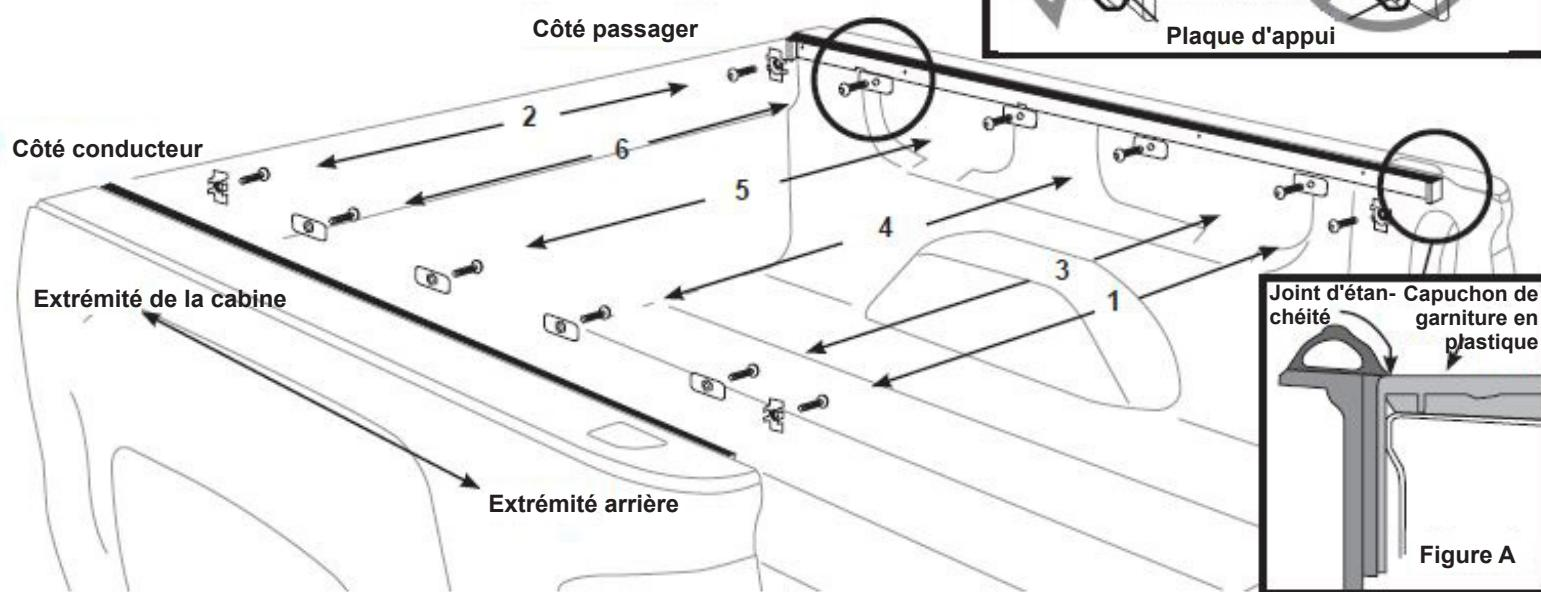
**Fixer les crochets du dispositif de serrage fixe :**
