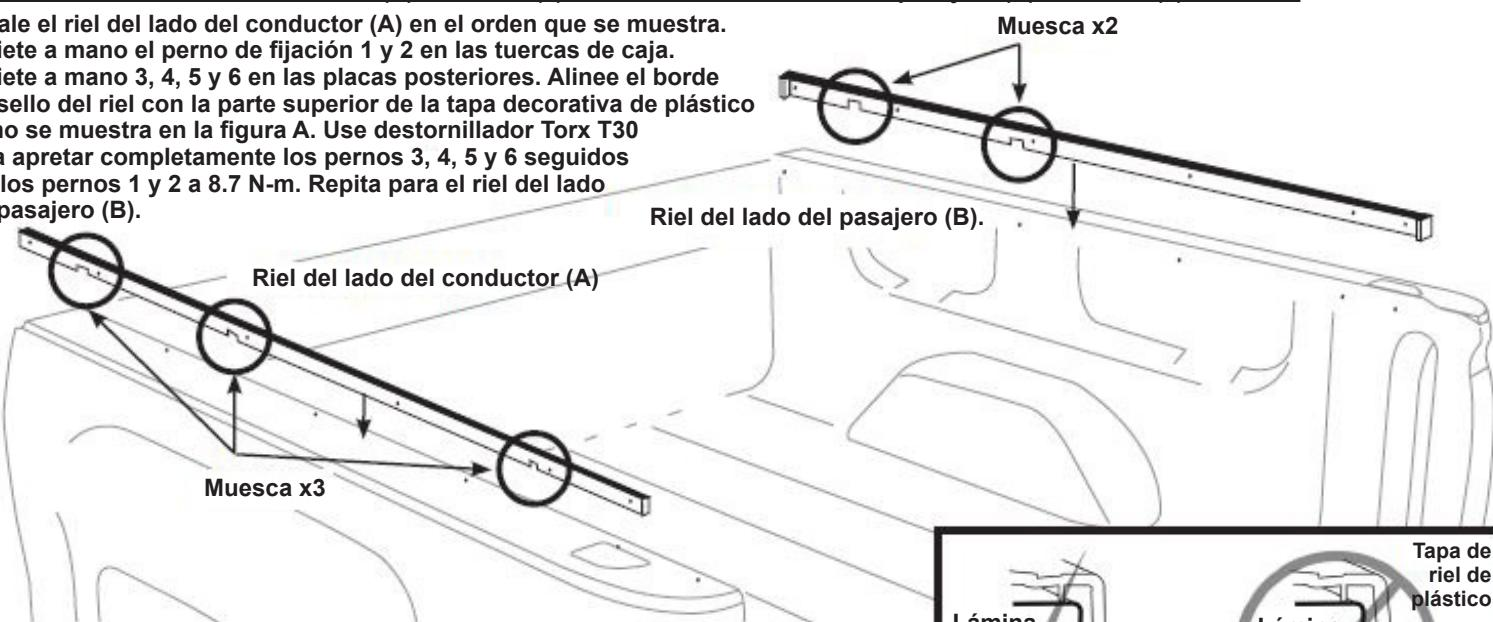
Las placas posteriores van instaladas en el lado de atrás de la lámina. NO instale las placas posteriores entre las tapas decorativas de plástico y la lámina.
