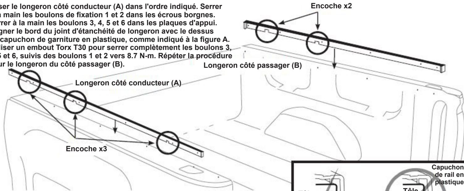
Les plaques d'appui se posent à l'endos de la tôle. NE PAS poser les plaques d'appui entre les capuchons de garniture en plastique et la tôle.
